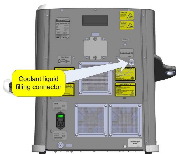
Figure 36: Remplissage de liquide de refroidissement
