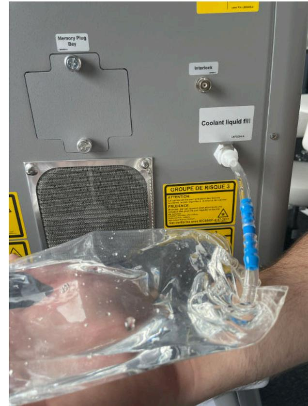
Insérez le tube dans le Coolant liquid fill et pressez sur la poche jusqu'à ce que l'eau arrive au niveau maximum mais sans jamais dépasser.
